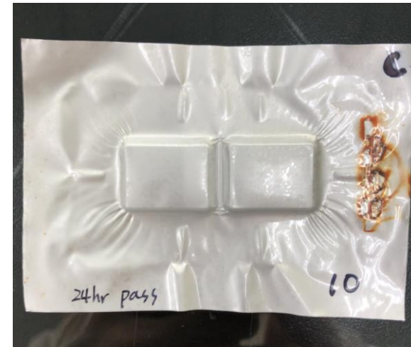
鋰電池鋁塑膜深沖測試示意圖
